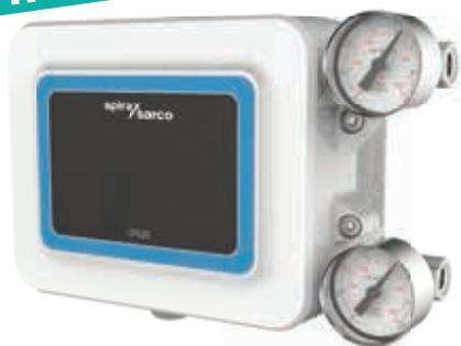
El posicionador se usa para garantizar la correcta ubicación del vástago de la válvula en relación a la señal de entrada, previniendo errores de histéresis y rozamiento y en casos donde la señal de salida del controlador no es suficiente para accionar el actuador.
