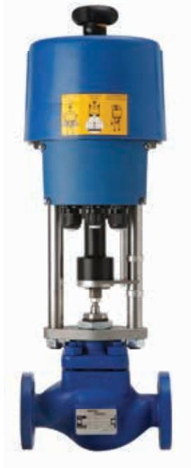
Serie AEL5 actuadores lineales eléctricos son para su uso con LE, KE y válvulas de control de dos puertos JE, QL válvulas de tres puntos y todos los fuelles sellados. Normalmente se suministran actuadores montados en la válvula de control. Cuando se suministra por separado, se aseguran que el actuador seleccionado es capaz de dar la fuerza necesaria para cerrar la válvula de control de dos vías o de tres vías en contra de la presión diferencial esperada.
