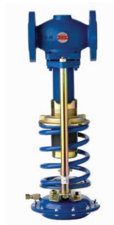
La DRV7-B es una válvula reductora de presión de acción directa con fuelles de sellado, construida en fundición nodular. La versión estándar tiene el diafragma de EPDM y es adecuada para vapor, agua y aire.
