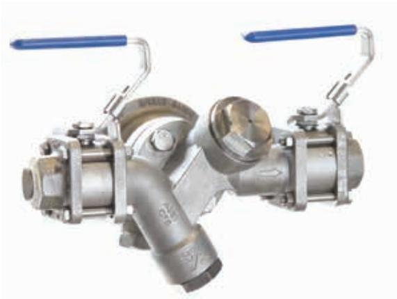
El STS 17.2 es un conector universal para trampas de vapor diseñado para uso en conjunto con las trampas de la serie "U". Su Diseño único integra 2 válvulas en una sola pieza, para aislar la trampa para vapor en el momento que ésta requiera mantenimiento.
