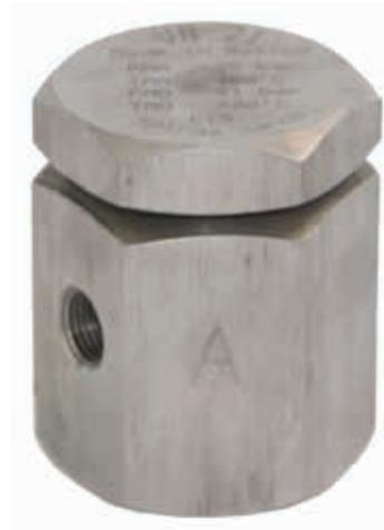
Protegiendo su planta y equipos de procesos de la creación de vacío. Al mismo tiempo permite que se drene el condensado de manera eficiente desde la tubería o recipientes de almacenamiento. El VB14 Y VB21 es un pequeño rompedor de vacío diseñado para utilización en sistemas con condensación de vapores (vapor) o sistemas de líquidos con presiones hasta 14 bar.
