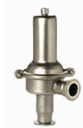
La SRV66 es una válvula reductora de presión sanitaria angular con autodrenaje de construcción en acero inoxidable 316 para usar con vapor, agua y gases inertes. Está disponible con conexiones compatibles con mordazas, no requiere una línea externa de detección de presión y tiene capacidad CIP.
